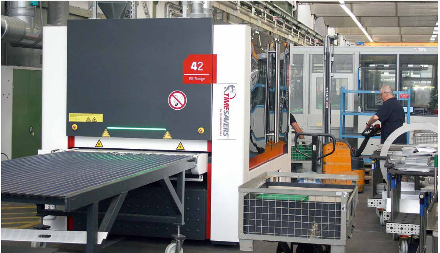
Im Werk Neutraubling sorgen zwei Maschinen vom Typ 42-Serie-WRB für ein sehr gutes Entgrat- und Verrundungsergebnis.
