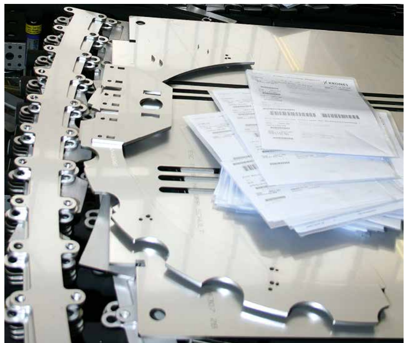
Gefertigt werden überwiegend kleine Stückzahlen auf Lasermaschinen. Die Teile werden vor der Weiterverarbeitung entgratet. Bild: Krones
