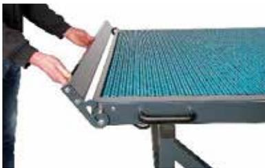
Bei der Beladung der Maschine mit Metallprodukten gibt es oft niemanden, der die bearbeiteten Teile entnimmt. Ein Puffertisch stellt sicher, dass die Teile bei der Bearbeitung gesammelt werden und bei Bedarf entnommen werden können. Der Bediener muss nicht an die Hinterseite der Maschine gehen und kann die Teile weiterhin zuföhren, was Zeit spart und die Produktivität erhöht.
