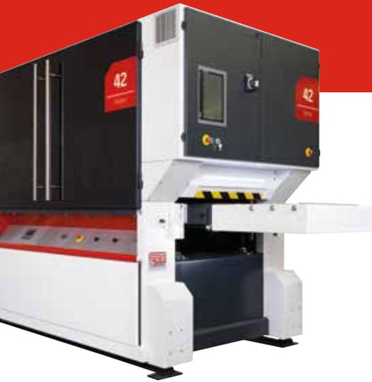
**Les machines à ébavurer de la 42 série de Timesavers sont disponibles en plusieurs largeurs** 900 mm, 1100 mm et 1350 mm. Les machines peuvent être fournies avec un maximum de quatre têtes avec différentes combinaisons de bande abrasive, de disque et de brosses. La machine peut ébavurer, faire des arrondis et la finition en un seul passage en intégrant différentes têtes, de façon homogène.
