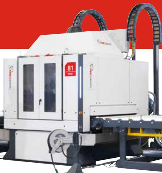
La machine 81 series est la solution innovante de Timesavers pour l'ébavurage de précision des métaux.
